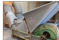
Un aérograngeur couplé à un moteur électrique Photo DNA
